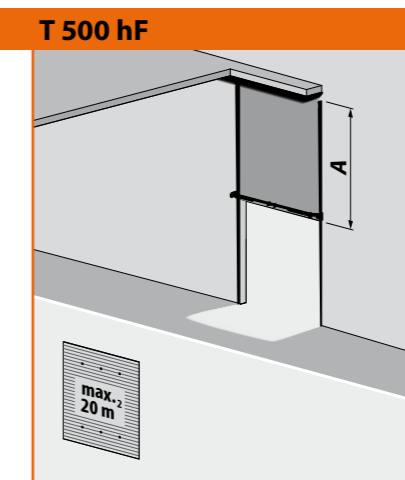
T 500 hF Verticaal railsysteem met laagliggende veeras + stalen draagprofiel
