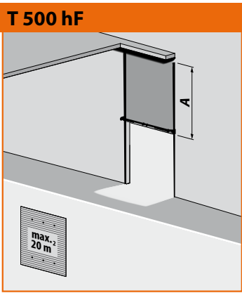
T 500 hF Verticaal railsysteem met laagliggende veeras + stalen draagprofiel A= daghoogte + 400 mm, Breedte max. 4.500 mm
