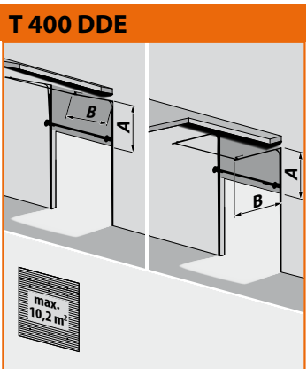
T 400 DDE Veerloze verhoogd railsysteem A= heffing + 200 mm B= daghoogte – heffing + 600 mm Breedte max. 3.200 mm Hoogte max. 3.200 mm Heffing min. 1.700 mm
