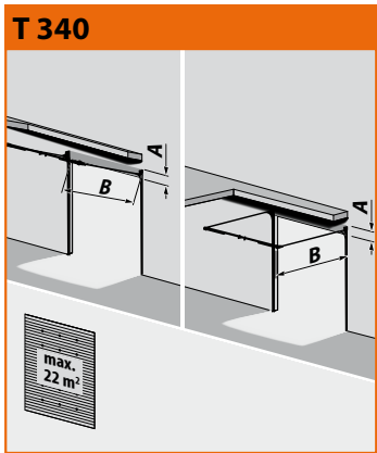
T 340 Normaal railsysteem, verenpakket achter + stalen draagprofiel A= 340 mm B= daghoogte + 750 mm Breedte max. 6.500 mm
