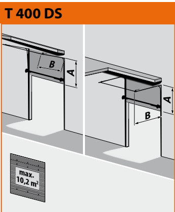
T 400 DS Verhoogd railsysteem met laagliggende veeras A= heffing + 200 mm B= daghoogte – heffing + 600 mm Breedte max. 3.200 mm Hoogte max. 3.200 mm Heffing min. 1.700 mm
